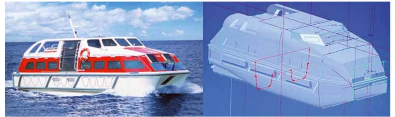
Als Ausgangspunkt für ein reales 3D-Teil können Bilder und Skizzen dienen – in diesem Beispiel des Rettungsboots eines Kreuzfahrtschiffs. Am Computer wird daraus ein CAD-Modell entworfen, das sodann als 3D-Druckvorlage dient
