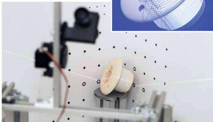
Verfügt man über ein Muster-Teil, egal ob funktionsfähig oder in Bruchstücken, kann sich die Erstellung des druckfähigen CAD-Modells vereinfachen. Per 3D-Laserscanner lassen sich Objekte in den Computer einlesen und für den Druck aufbereiten, in diesem Falle eine Swimmingpool-Düse
